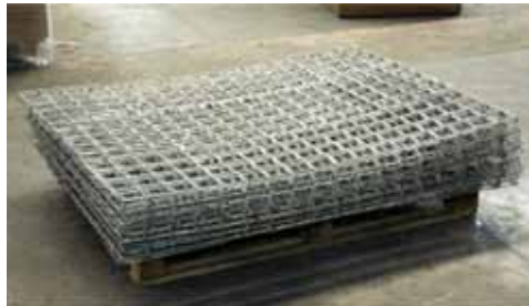
Los gaviones Pro se suministran en paneles sueltos sobre un palet
